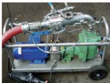
pump med injektor
