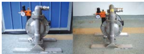
Bild 6.7: Luftdriven syrafast pump för bl a högviskösa vätskor (Bilder: ØSA och Hylander)
