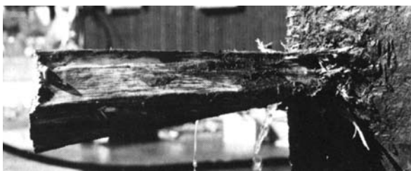
Bild 4.3: Dåligt tilltyxad kil utan densotejp
