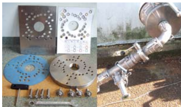
Bild 6.12: Sparflänssats och principiell uppbyggnad av ett pumpsystem (Bilder: L. Hylander)
