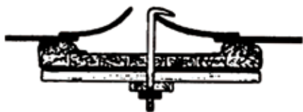
Bild 4.13: Funktionen hos en tätningstving (Bild: Kustbevakningen)
